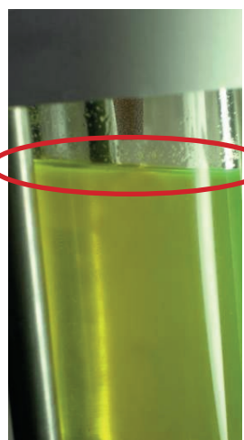
Støv og partikler i kuldemediet Visuell inspeksjon for å bestemme graden av skade.
