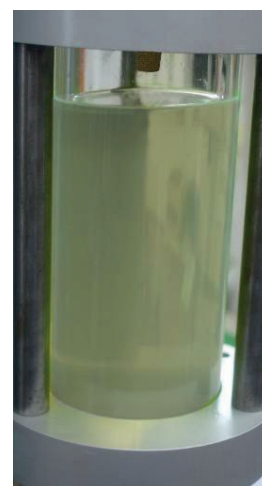
Kuldemedium blanding med kompressor feil.
