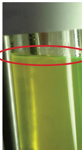
Staub und Schmutzpartikel im Kältemittel
