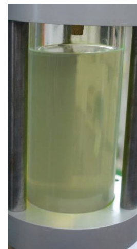
Verschmutztes Kältemittel, Kompressor defekt.
