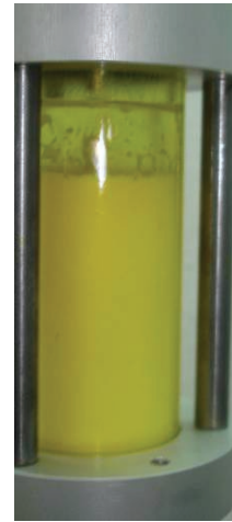
Ungenügend vermishtes Öl und Kältemittel.
