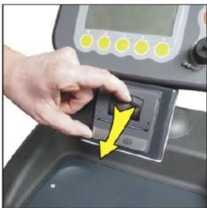
Ouverture du cache d'imprimante
