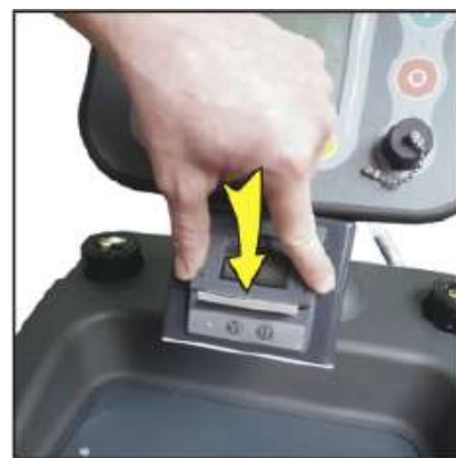
Fermeture du cache d'imprimante
